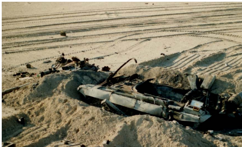
ФОТО 26. Подбитый иракский танк в окопе, 1991 г. Видна толщина бруствера и отсутствие заглубления в грунт [из альбом Fait, 1992. Автор: Sophie Ristelhueber]
