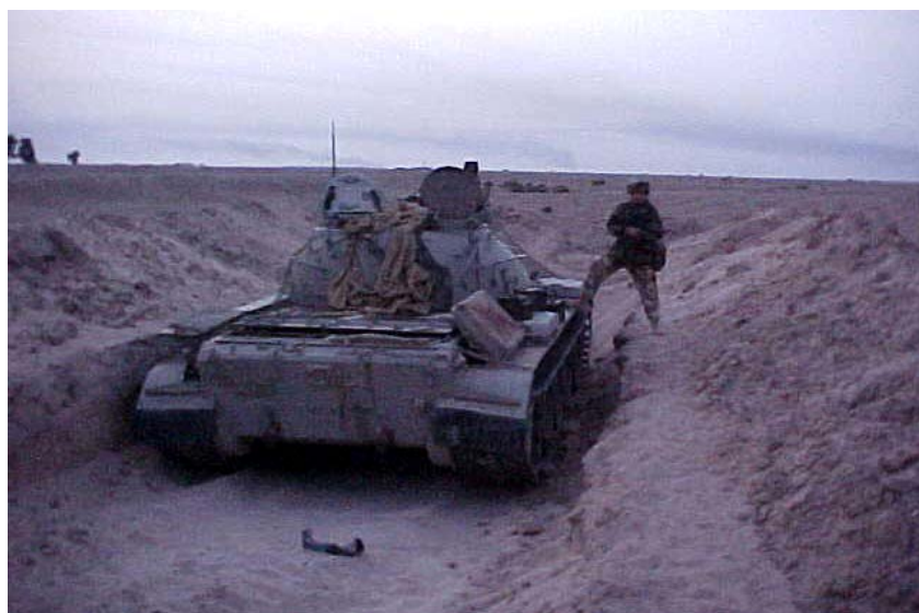
ФОТО 32. Иракский танк в окопе. Видно, что высота боковых брустверов затрудняет стрельбу вбок
