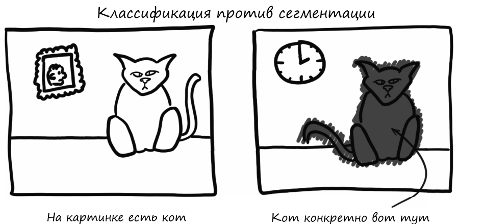
Рис. 13.3. Результатом классификации является один или несколько бинарных флагов, а сегментация создает маску или тепловую карту
