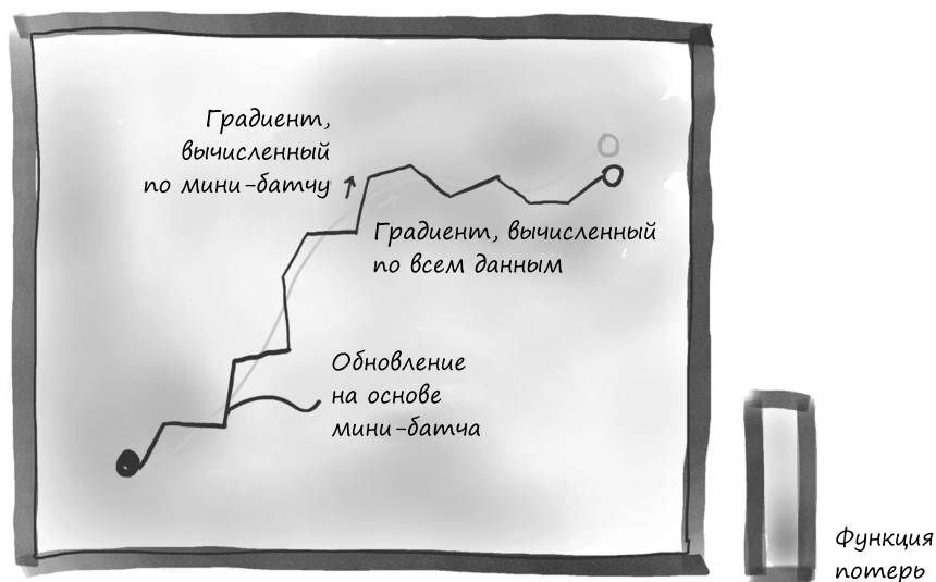
Рис. 7.13. Градиентный спуск с усреднением по всему набору данных (бледная линия), по сравнению со стохастическим градиентным спуском, где градиент вычисляется по выбираемым случайным образом мини-батчам
