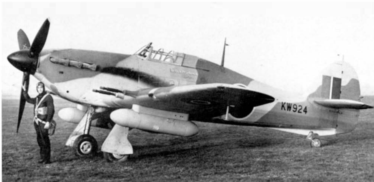
Поздний «Харрикейн» IIC с подвесными баками. Камуфляж – «пустынный»
