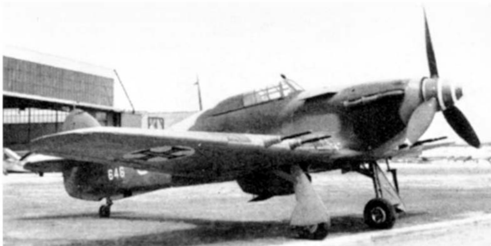
Португальский «Харрикейн» ИС со щитками ночного истребителя
