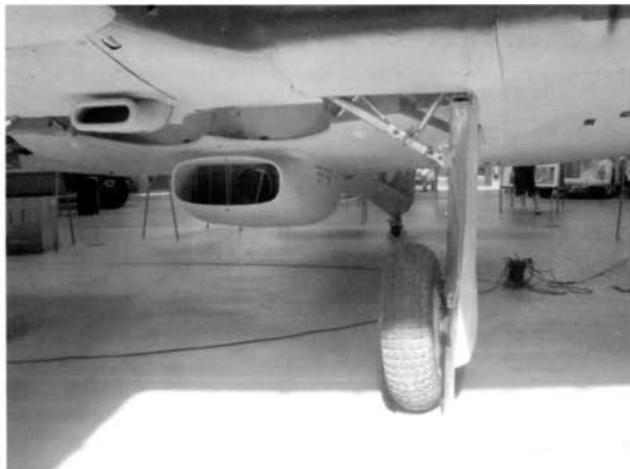
Стойка шасси и радиатор
