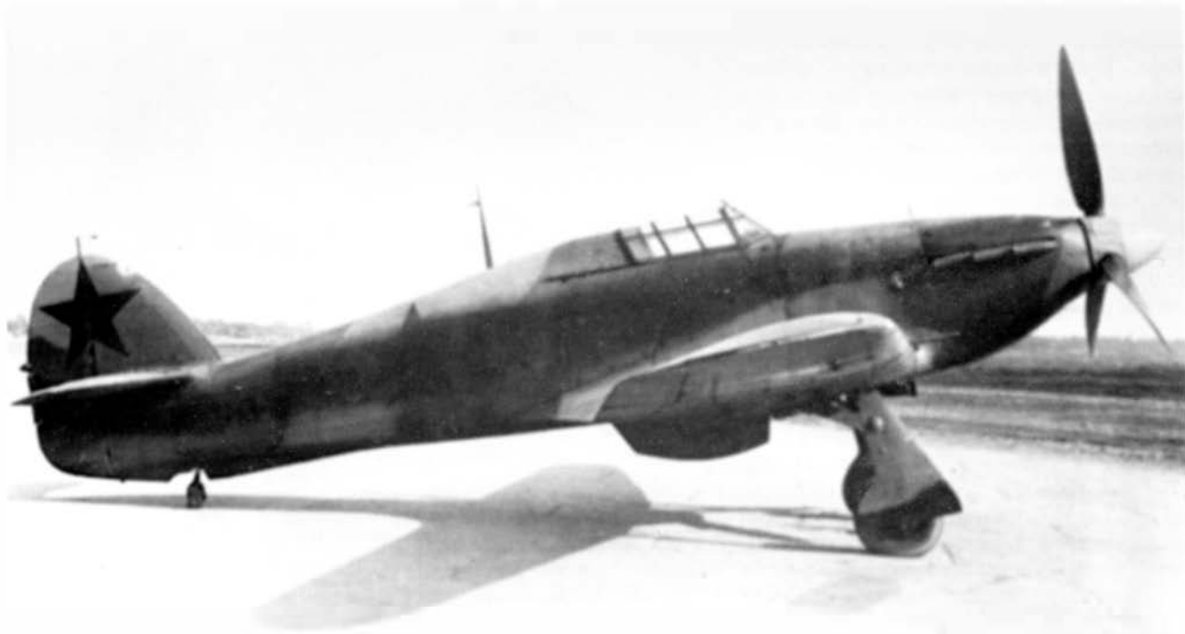
«Харрикейн», переделанный под советское вооружение – две пушки ШВАК и два пулемета УБТ, на испытаниях в НИИ ВВС
